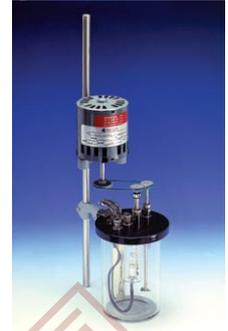
按照B-搅拌法测定苯胺点和混合苯胺点，即将热浴中硼硅玻璃薄膜管内的苯胺-样品混合物搅拌后测定。混合物薄膜溢出光井时会被可调6V灯照射。选购电力加热器依据标准要求调节加热速率。混合物冷却，两相分开时灯丝变暗。正向驱动系统用来旋转样品，浴搅拌器用于搅拌浴介质。选配动力加热器具有连续可调控制功能。
