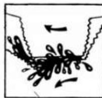
润滑油被挤出造成齿牙双面磨损双面磨损
