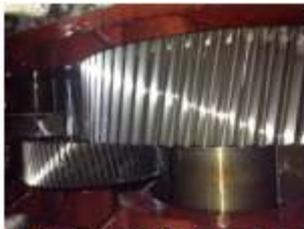
1.1#张力辊齿轮箱-齿面无磨损
