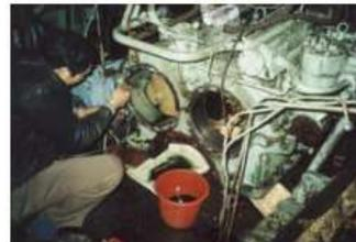
**产生原因：**（1）齿轮箱停机后冷凝水进入齿轮箱，温差变化促进呼吸作用；（2）通过齿轮箱呼吸口进入；（3）润滑油中含有水分；（4）密封泄露进入水分。
